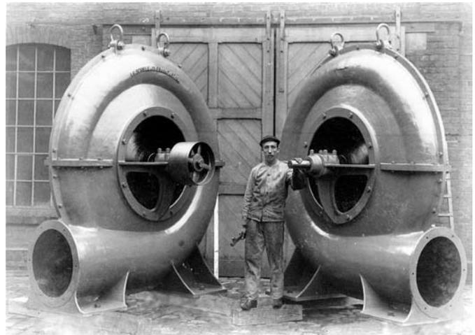
G. Schiele & Co. lieferte im November 1900 zwei Hochdruck-Ventilatoren an die Deutsch-Österreichischen Mannesmann-Röhren-Werke in Komotau (Böhmen).
