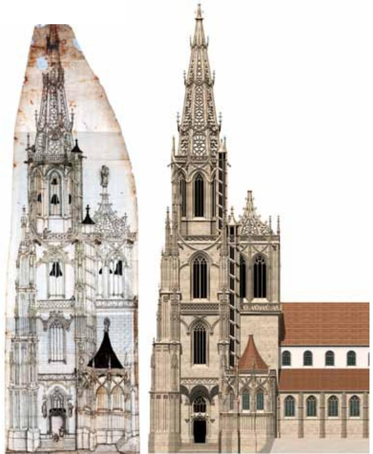
Abb. 1 (links): Bauriss des Konstanzer Münsters im Hessischen Hauptstaatsarchiv. Abb. 2 A (rechts): Rekonstruktion der Planungen des Lux Böblinger zum Westbau des Konstanzer Münsters: Parallelprojektion von Süden.
