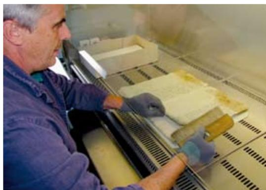
Reinigungsarbeiten an der Sicherheitswerkbank
